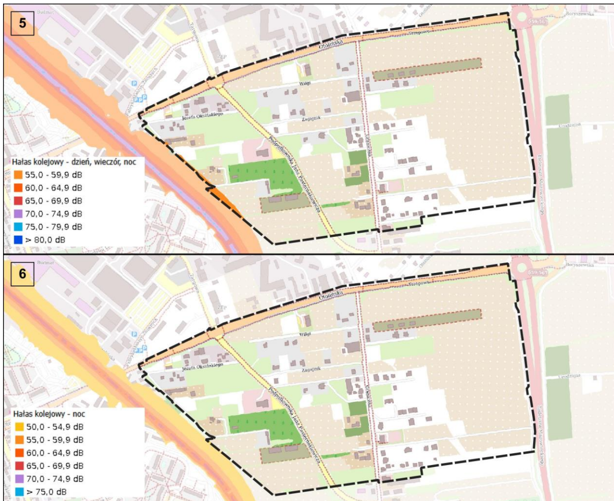
Ryc. 10. Występowanie hałasu kolejowego w porze dzień-wieczór-noc (LDWN) [5] i w porze nocnej (LN) [6] w obszarze objętym projektem planu
